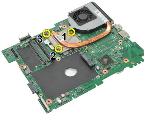
18. Sollevare il dissipatore di calore ed estrarlo dal computer.
