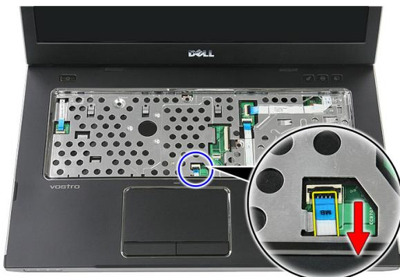
11. Sbloccare il clip di fissaggio del cavo della scheda del pulsante di avvio rapido.
