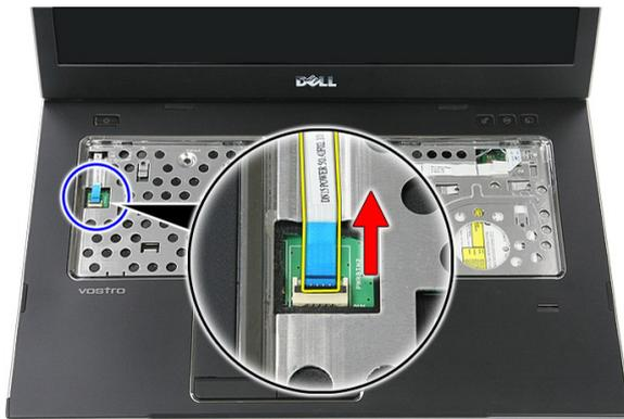
9. Sbloccare il clip di fissaggio del cavo dati del touchpad.
