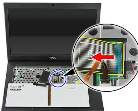
7. Se il computer viene fornito con una tastiera retroilluminata, aprire il clip di fissaggio del cavo della retroilluminazione della tastiera.
