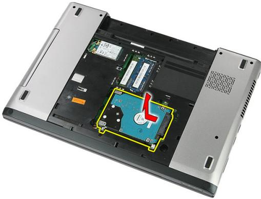
6. Rimuovere le viti che fissano il supporto del disco rigido al disco rigido.
