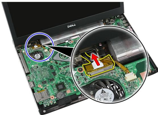
11. Se il computer viene fornito con pannello a sfioramento, scollegare il cavo del pannello.
